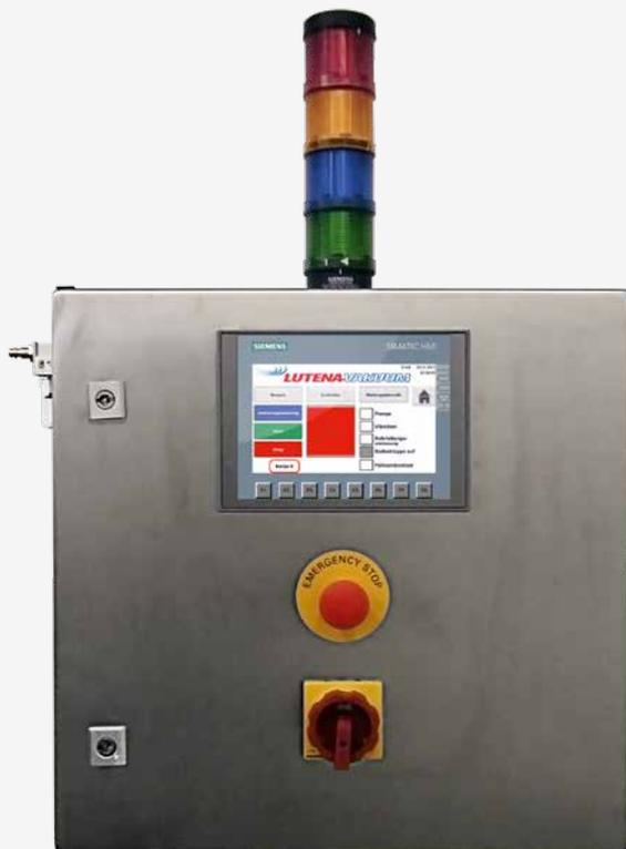
Die CCLUR verarbeitet Niveau-Meldungen von Min/Max und steuert die Austragshilfe (Vibration) sowie die Rohrleitungsentleerung. Auch die Ansteuerung von nicht zum Vakuurförderer gehörende Bauteile sind möglich.
