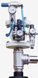
Bei dem Einsatz von elektrischen Vakuumpumpen ist es notwendig die Vakuumzufuhr zum Förderer zu unterbrechen und diesen zu belüften.
