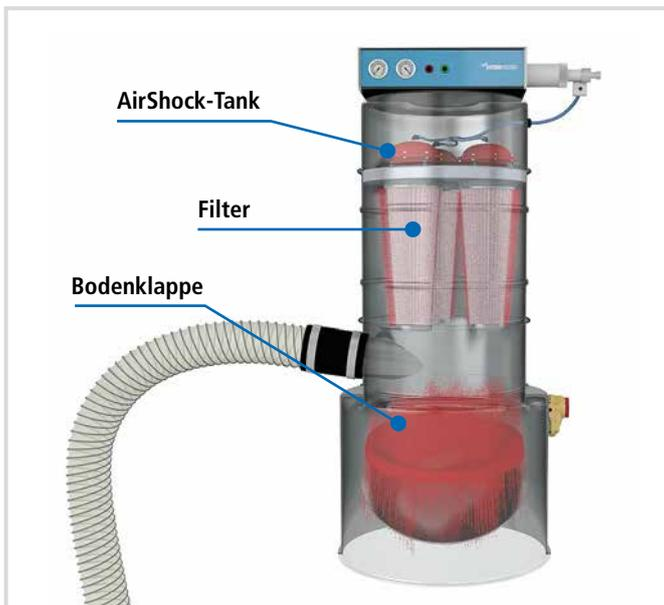
Das geförderte Produkt wird im Filtergehäuse zuverlässig von der Trägerluft getrennt. Nach Durchlauf eines Förderzyklus wird das Produkt über die Freiflussklappe abgegeben. Anschließend werden nach jedem Förderzyklus die Filter durch unser Airshocksystem gereinigt, um ein gleichbleibend hohes Förderergebnis zu gewährleisten.
