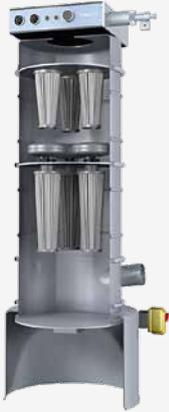
In Bereichen in denen mit neuralgischen Stoffen gearbeitet wird oder wo eine regelmäßige Kontrolle der Filter in einem Vakuumförderer nicht gewährleistet werden kann, kommt unsere Polizeifilterstufe zum Einsatz. Eine Polizeifilterstufe beinhaltet eine doppelstöckige Filterkammer. Schlägt die erste Filterstufe durch, kommt die zweite Filterstufe als effektiv arbeitende dazu.
